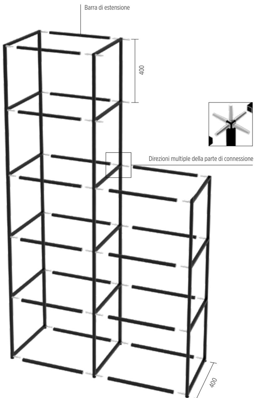
Le barre di alluminio formano la base di costruzione del sistema. Hanno uno spessore di soli 15 mm e sono disponibili in colore standard grigio alluminio, oppure con verniciatura a polvere in colore nero o bianco.
